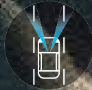
LANE DEPARTURE WARNING (LDW) เทคโนโลยีเตือนเมื่อรถออกนอกช่องทาง
