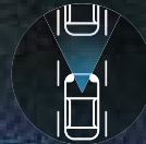
INTELLIGENT FORWARD COLLISION WARNING (IFCW) เทคโนโลยีเตือนเมื่อเสี่ยงต่อการชนจากริยะ: ทำงานร่วมกับ INTELLIGENT EMERGENCY BRAKING (IEB) เทคโนโลยีเบรกฉุกเฉินอัจฉริยะ:
